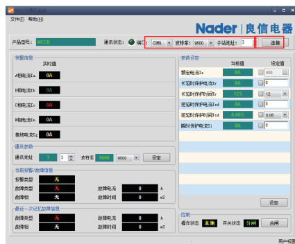
图 6：“MCCB 通讯系统.exe”软件运行界面
